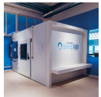
Die Klimakammer Mit dieser revolutionären Testeinrichtung wird das Mikroklima auf und in der Matratze gemessen.
